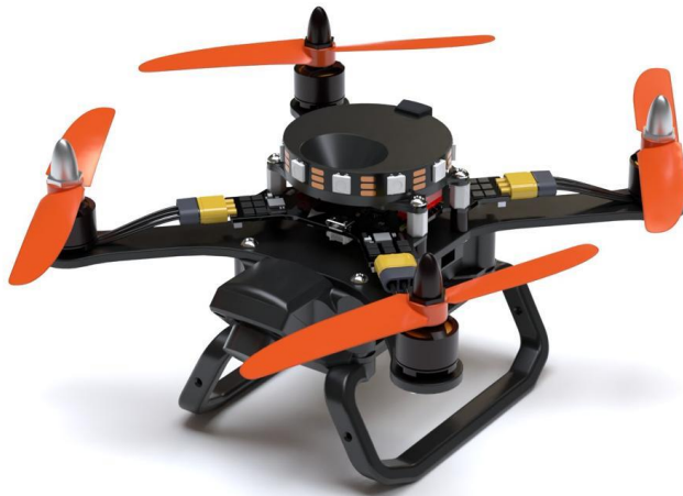
Рисунок 1 – КБЛА «Геоскан Пионер»
