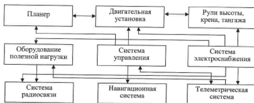
Рисунок 5 - Взаимосвязь основных подсистем БЛА
